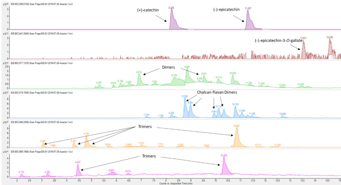
Figure 2. Exemple de balayage ESI-SIM de l'acacia
