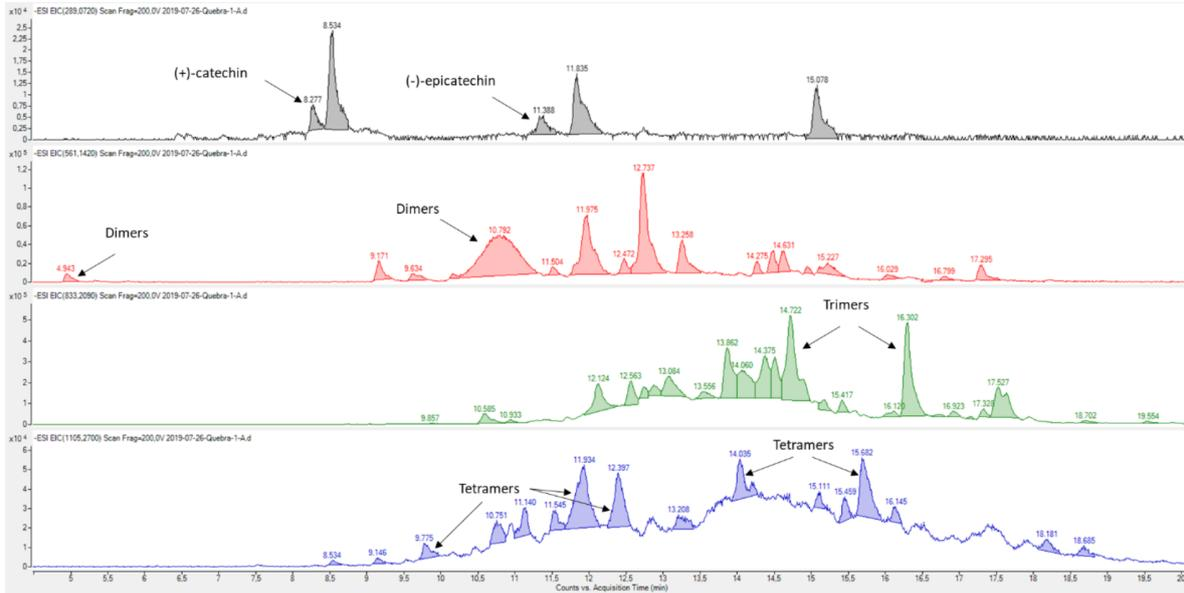
Figure 1. Exemple de balayage ESI-SIM du quebracho
