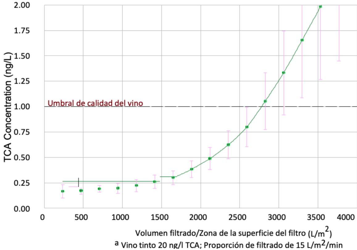
La curva de ruptura se generó utilizando un número de placas comerciales elaborados en diferentes fechas de producción.
