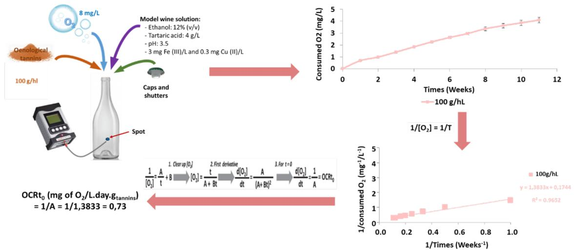
Figura 4. Procedimiento para determinar la tasa de consumo de oxígeno
