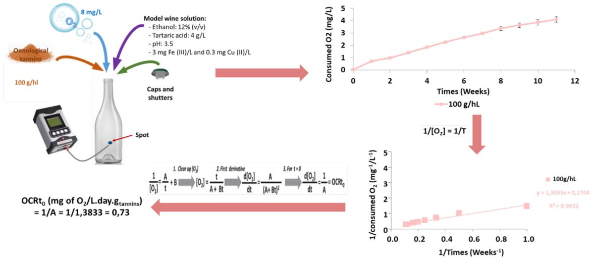
Figura 3. Procedimiento para determinar la tasa de consumo de oxígeno
