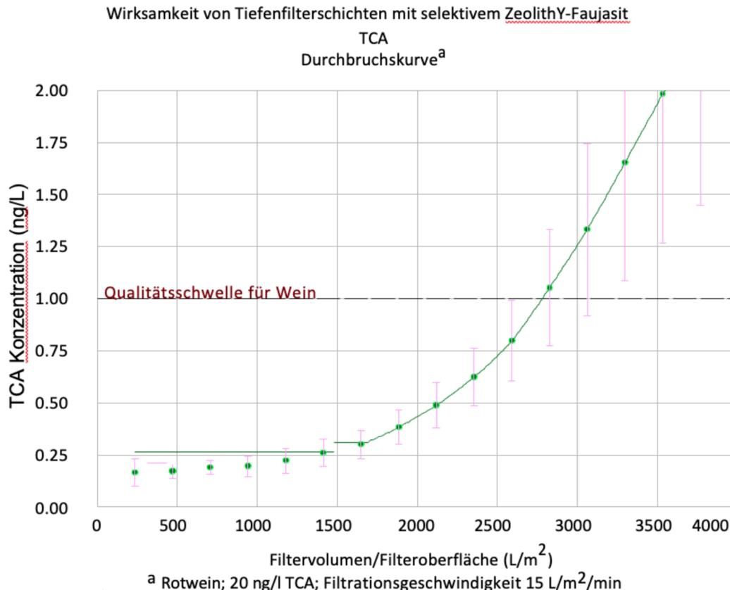
Die Durchbruchskurve wurde unter Verwendung von handelsüblichen, an unterschiedlichen Daten hergestellten Filterschichten erstellt.
